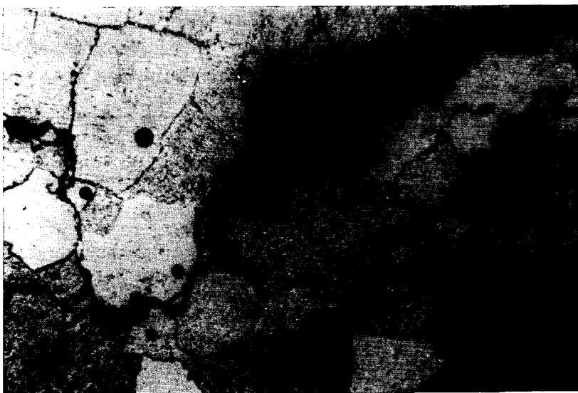
Figura 12.—Estructuras estilolíticas (residuos de materia carbonosa con opacos asociados) en roca ankerítica. Toda la ankerita que se observa en la foto es hidrotermal. Muestra SC-4', mina San Carlos, 3.ª planta (N//, 45×).
