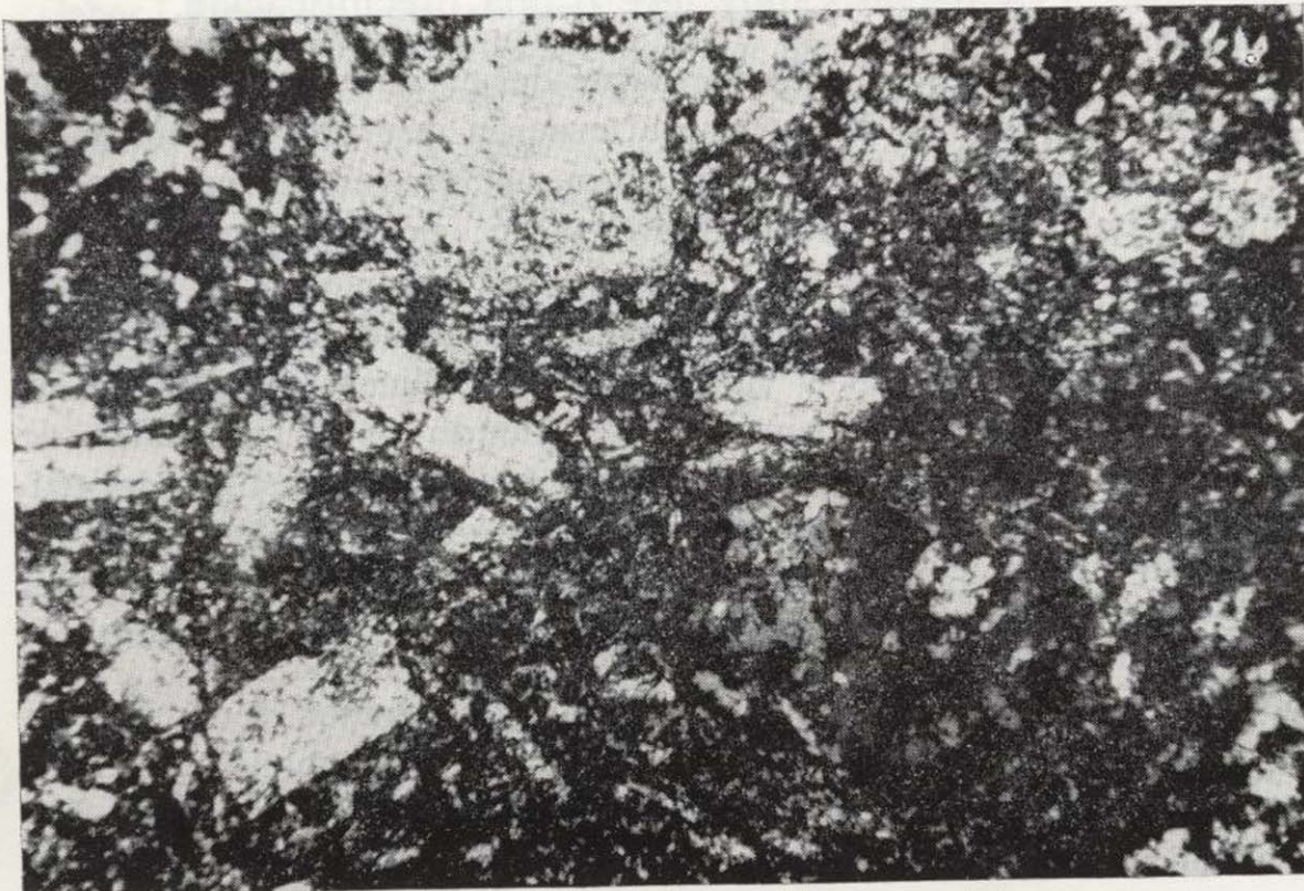
Figura 10.—Hidrotermalización de un pórfido diorítico anfibólico: sericitización de la plagioclasa y carbonatización del anfíbol. Seudomorfos de plagioclasa: cristales tabulares blanquecinos. Fenocristales prismáticos de anfíbol sustituidos por completo por limonita (negra) y calcita (gris). Muestra 107 bis, Bco. Pocet; cota 1.550 m. (NX, 45 \times ).
